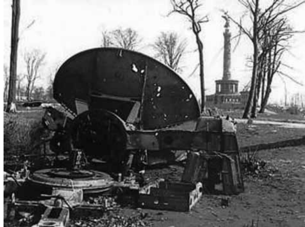
Fot. 1.11. Stacja radiolokacyjna FuMG 62 Würzburg do kierowania ogniem armat przeciwlotniczych i reflektorów zniszczona w Berlinie, w rejonie walk polskich żołnierzy
