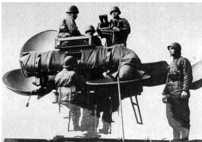
Fot. 1.5. Nastuchownik austriackiej firmy „Goerz” podczas pracy. Fotografia wykonana w sierpniu 1939 r. w 1. paplot w Warszawie. Polska miała tylko 8 tych urządzeń
