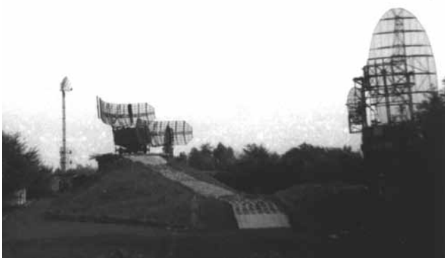
Fot. 6.95. Posterunek radiotechniczny. Od lewej: maszt anteny „Wetlina”, stacja P-37 i stacja PRW-11
