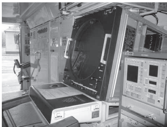
Fot. 6.98. Wskaźnik w kabinie stacji NUR-31
