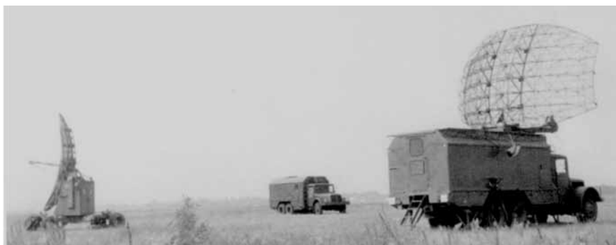
Fot. 6.94. Posterunek radiotechniczny składający się ze stacji „Jawor” (po prawej) i wysokościomierza „Bogota” (po lewej)
