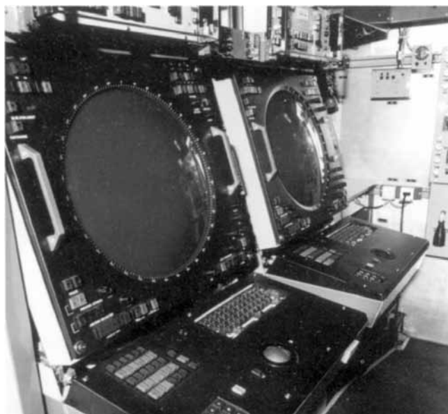
Fot. 6.94. Posterunek radiotechniczny składający się ze stacji „Jawor” (po prawej) i wysokościomierza „Bogota” (po lewej)
