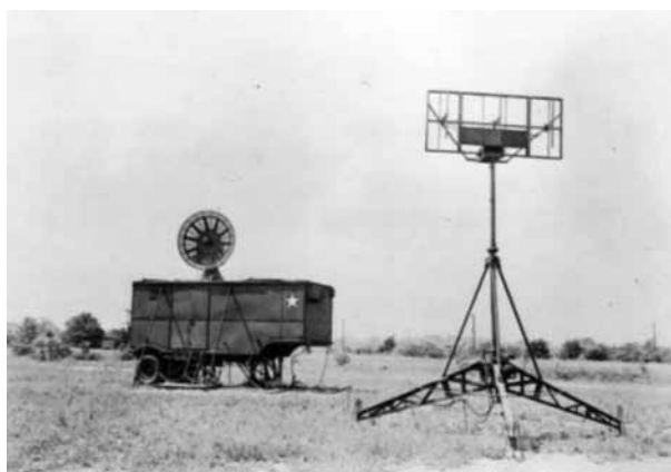
Fot. 1.17. Amerykański radar SCR-584 i antena urządzenia IFF (foto. z 1944 r.).
